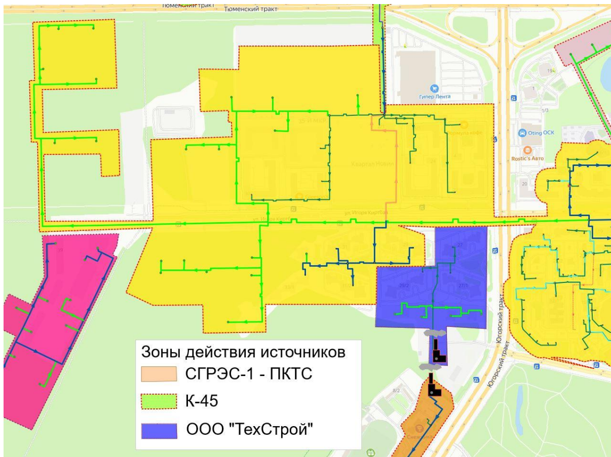
Рисунок 1.28 – Зона действия СГРЭС-1 – ПКТС после переключения потребителей микрорайона 35 с котельной К-45
